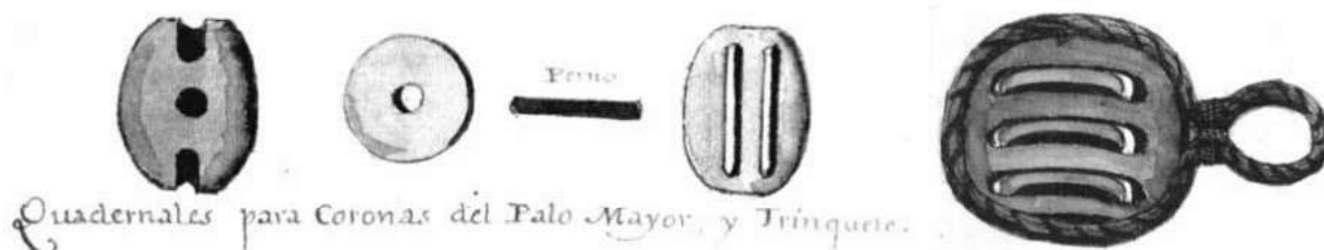
Figura 10.4 - A la izquierda, despiece de un cuadernal de dos ojos. A la derecha, cuadernal de tres ojos ya guarnido con su gaza. Hoja 54 del AMV. Museo Naval, Madrid.
