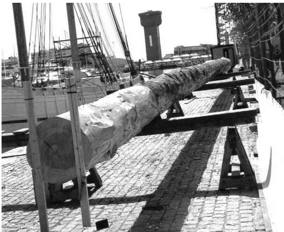
Figura 9.2 – Un palo del pailebote Santa Eulalia preparado para ser labrado. Obsérvense los dos listones clavados verticalmente en su extremo que sirven para soportar los cordeles utilizados como guías para escuadrar el tronco. Fotografía de C. Hormaechea.
