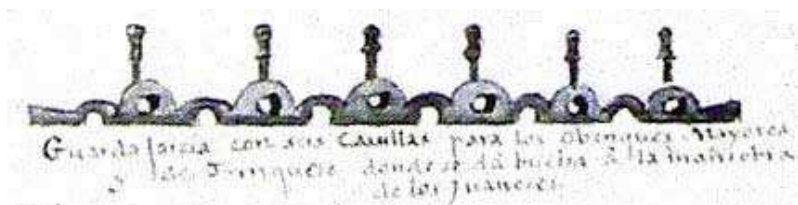
<= Figura 10.18 Guardajarcia y cabillero en una pieza. Hoja 54 del álbum del Marqués de la Victoria. Al parecer, este elemento no apareció hasta el siglo XVIII.
