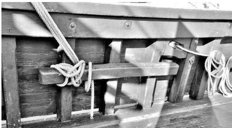
Figura 10.22 - Escaldrana en la réplica de la nao Victoria . A la derecha se observan una escotera y una cornamusa.
