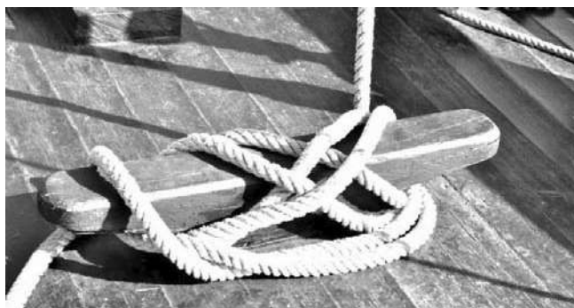
Figura 10.19- Una cornamusa situada en la cubierta de la réplica de la nao Victoria . Fotografía de C.H.
