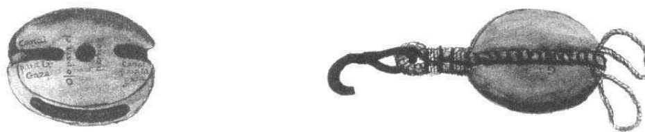
Figura 10.2: Motón con descripción de sus partes según la lámina 54 del AMV, Museo Naval, Madrid. A la izquierda el cuerpo del motón con su cajera o reclame para alojar la roldana, el ojo para el perno que sirve de eje para la roldana, y el canal para la gaza. A la derecha un motón guarnido con gaza , gancho y estribos para hacer firme la beta.
