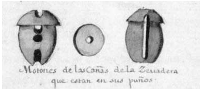
Figuur 10.2: Moton met beschrijving van de onderdelen volgens plaat 54 van de AMV, Museo Naval, Madrid. Links het lichaam van het blok met zijn Kassa of beweren om de schijf te huisvesten, de oog voor de asbout voor de schijf, en de kanaal voor de gaza. Rechts een blokje gegarneerd met gaas haak en stijgbeugels om de bèta stevig te maken.
