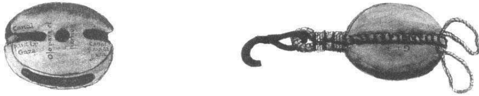
Figuur 10.2: Moton met beschrijving van de onderdelen volgens plaat 54 van de AMV, Museo Naval, Madrid. Links het lichaam van het blok met zijn Kassa of beweren om de schijf te huisvesten, de oog voor de asbout voor de schijf, en de kanaal voor de gaza. Rechts een blokje gegarneerd met gaas haak en stijgbeugels om de bèta stevig te maken.
